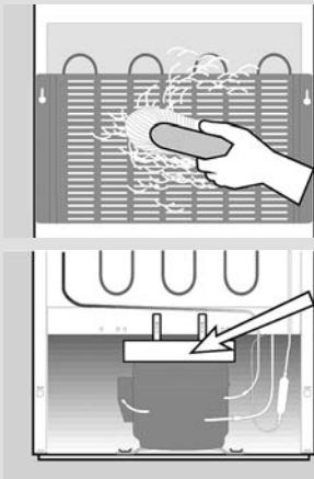
**Перед очисткой выключите аппарат из электросети** (извлеките вилку сетевого шнура из розетки). Специальная антибактериальная защита - внутреннее покрытие стенок аппарата - предотвращает размножение бактерий и поддерживает чистоту внутри аппарата. При очистке обязательно тщательно удалите все остатки чистящих и моющих средств.
